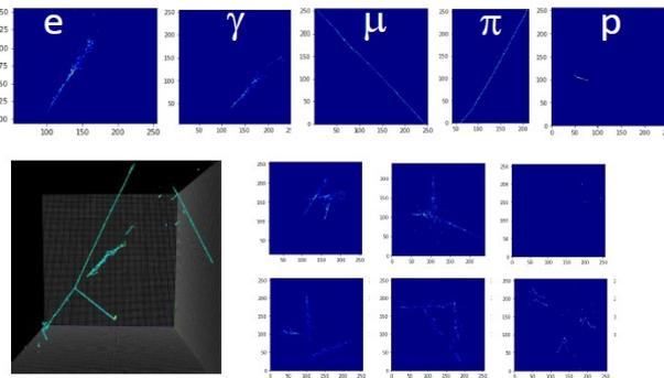
Images: - projections en 2D des images 3D de l'énergie déposée par les particules dans le détecteur - 3\*2D images de (256 x 256) Pixels
